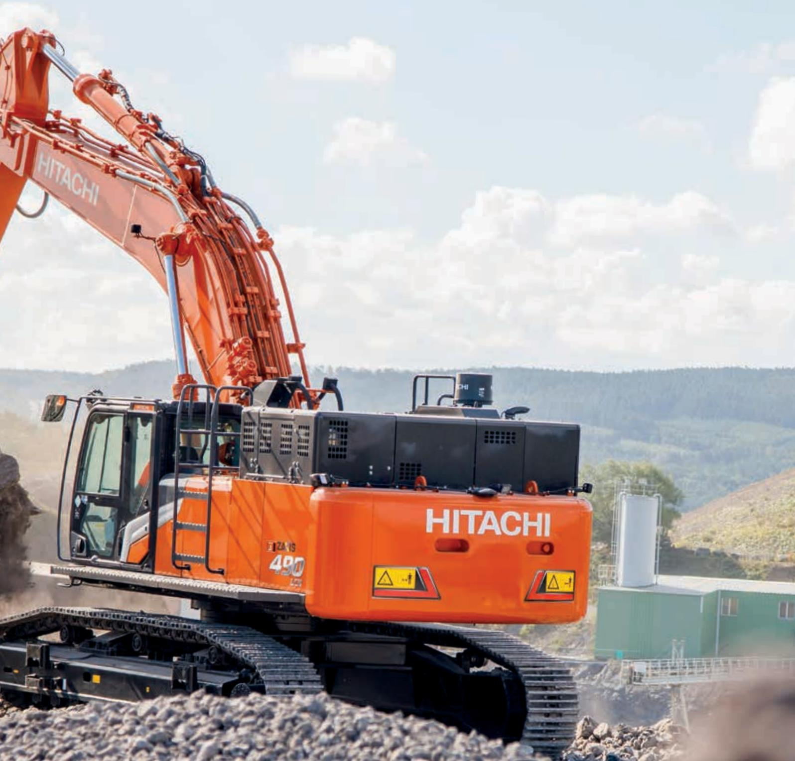
Il circuito idraulico HIOS V fa aumentare la velocità di avanzamento per migliorare la produttività.
