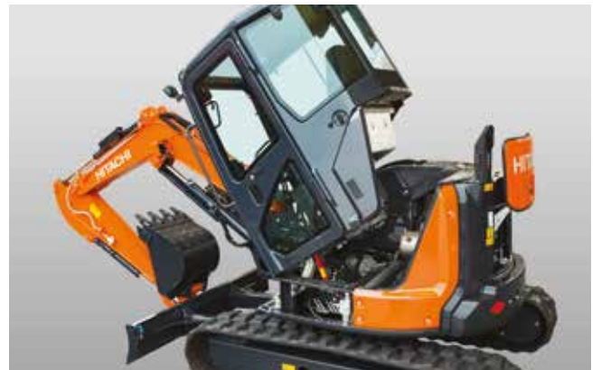
Il pavimento inclinabile consente un facile accesso al motore e alla valvola di controllo, per velocizzare la manutenzione.
