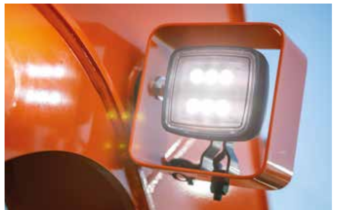
I fari a LED durano più a lungo di quelli alogeni.
