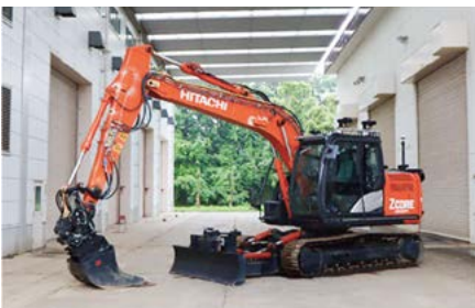
ZCOREを適用した協調型建設機械のプロトタイプ機 Prototype excavator applied with ZCORE
