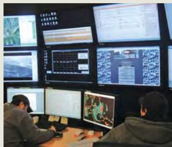
FMSは車両の稼働状況を把握して鉱山全体の生産効率を向上させて、刻々と変化する状況下で安全運行の指示と管理を行う。
