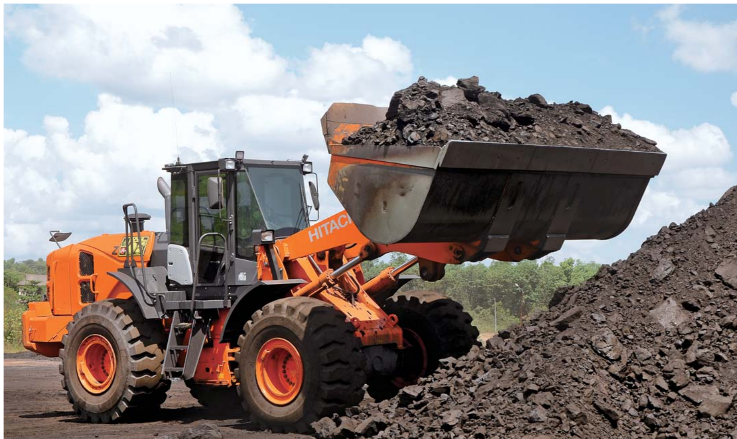
ZW310-5Aは、エコモード機能により、最大積載量を積んだ状態でも長時間燃料効率を保つことが可能。また、自動化された可逆冷却ファンも備えているため、最小限のメンテナンスで済むことも生産性の向上につながった。
