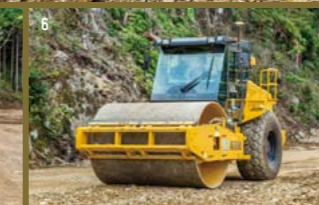
4. GNSS基準局のアンテナから、ICT建機の受信機に位置情報や施工設計データが送られる。5&6. マシンガイダンス機能を後付けした他社製の20tクラスのブルドーザー、10tのロードローラー。モニター上で機械の位置情報と設計データを確認しながら施工にあたる。7. 尾花組が所有する重機60台は、グループ会社である藤田株式会社で工場にて修理・整備を行う。「いつ要請があっても応えられるように、常に準備をしています」と語る工場長の尾花幸蔵氏。
