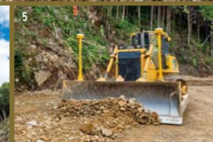
4. GNSS基準局のアンテナから、ICT建機の受信機に位置情報や施工設計データが送られる。5&6. マシンガイダンス機能を後付けした他社製の20tクラスのブルドーザー、10tのロードローラー。モニター上で機械の位置情報と設計データを確認しながら施工にあたる。7. 尾花組が所有する重機60台は、グループ会社である藤田株式会社で工場にて修理・整備を行う。「いつ要請があっても応えられるように、常に準備をしています」と語る工場長の尾花幸蔵氏。
