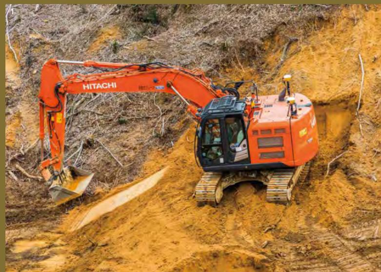
1. ICT施工に対応した日立建機の油圧ショベルZX225USRが稼働している。法面形成はもちろん、傾斜のある土地の整地で大きな効果を発揮している。
