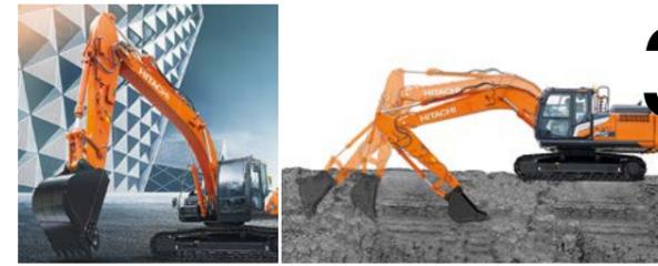
新型7型機。新開発のマシンコントロールで作業スピードが向上し、オペレータの負担を低減
