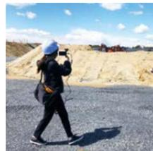
Solution Linkage Survey. スマホを持って、盛り土をぐるりと一周すれば土量を計測できる
