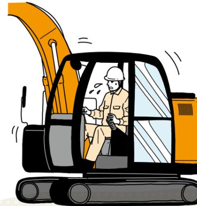
土木工事や建築基礎工事などで、オペレータの操作をアシストすることを目的に開発された独自のマシンコントロール機能(Solution Linkage Assist)を搭載したのが、日立建機のICT油圧ショベルの新型機「ZX135USX-7、ZX200X-7、ZX330X-7」だ。若手でも、さまざまな現場で正確に作業ができるように支援機能が搭載されている。油圧ショベルの旋回動作時にフロント部が設定した境界に近づくと、動作を減速して停止する「エアアコントロール」機能が新たに搭載され、狭所や障害物のある現場での安全性向上にも貢献。
