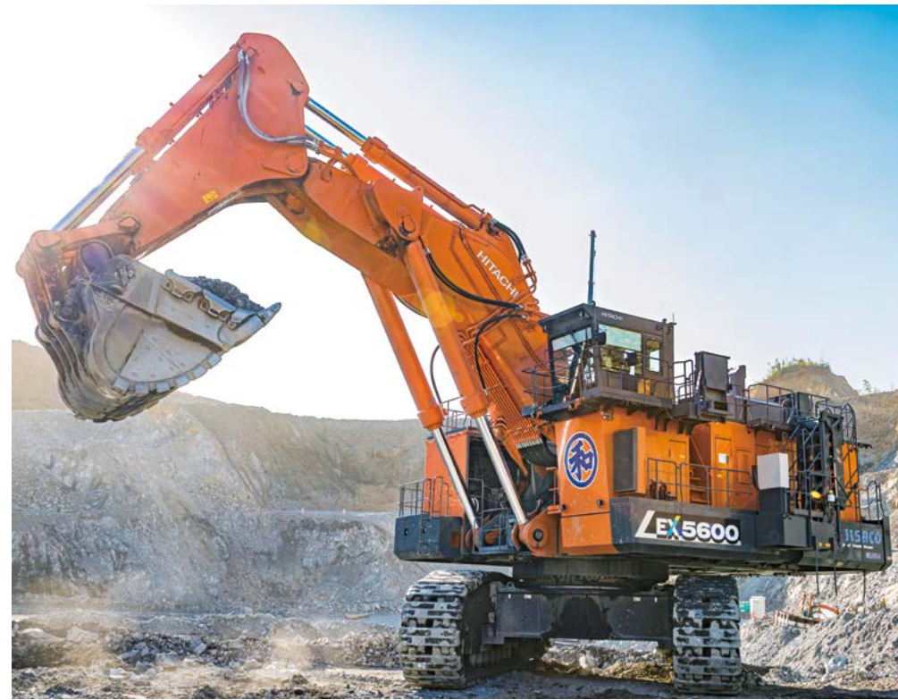
1. 音坂工場の掘削現場最前線でパワーを発揮する EX5600-7。生産性、耐久性、操作性、居住性など、すべてにおいてトータルバランスを追求した設計思想が結実。重量は約550t、車幅は最大10.3m、キャブ上までの高さは約8.7mと圧巻のスケールだ。 2. 油圧配管がブーム一面に配置されており、ハードな碎石作業でパワーを発揮している。
