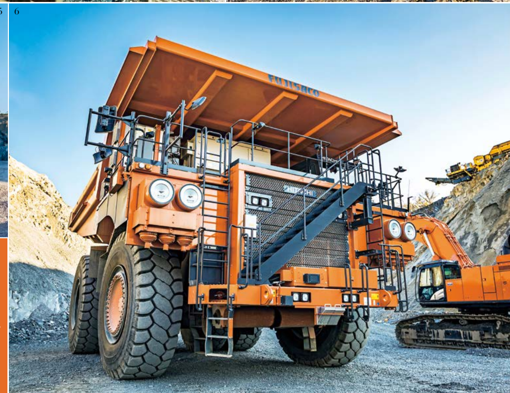
5&6. 積載質量180tクラスのリジッドダンプトラック EH3500AC-3 は、超大型油圧ショベルの相番機にふさわしい性能だ。車体の状況を把握するセンサ類と、制御機器の高性能化を追求。凹凸や高低差が激しく足場の悪い鉱山でも「高度車体安定化制御技術」が機能する。車体のスリップやタイヤロック、前後方向の揺れ、ステアリング時の横滑り緩和機能によって安全な走行性能を実現する。巨体を支えるタイヤのサイズも直径3.7mと超ビッグ。
