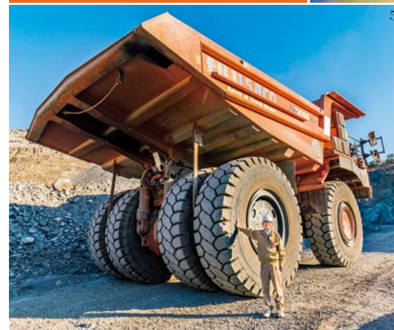
5&6. 積載質量180tクラスのリジッドダンプトラック EH3500AC-3 は、超大型油圧ショベルの相番機にふさわしい性能だ。車体の状況を把握するセンサ類と、制御機器の高性能化を追求。凹凸や高低差が激しく足場の悪い鉱山でも「高度車体安定化制御技術」が機能する。車体のスリップやタイヤロック、前後方向の揺れ、ステアリング時の横滑り緩和機能によって安全な走行性能を実現する。巨体を支えるタイヤのサイズも直径3.7mと超ビッグ。
