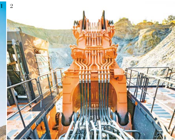
1. 音坂工場の掘削現場最前線でパワーを発揮する EX5600-7。生産性、耐久性、操作性、居住性など、すべてにおいてトータルバランスを追求した設計思想が結実。重量は約550t、車幅は最大10.3m、キャブ上までの高さは約8.7mと圧巻のスケールだ。 2. 油圧配管がブーム一面に配置されており、ハードな碎石作業でパワーを発揮している。
