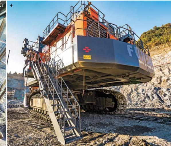
1. 音坂工場の掘削現場最前線でパワーを発揮する EX5600-7。生産性、耐久性、操作性、居住性など、すべてにおいてトータルバランスを追求した設計思想が結実。重量は約550t、車幅は最大10.3m、キャブ上までの高さは約8.7mと圧巻のスケールだ。 2. 油圧配管がブーム一面に配置されており、ハードな碎石作業でパワーを発揮している。
