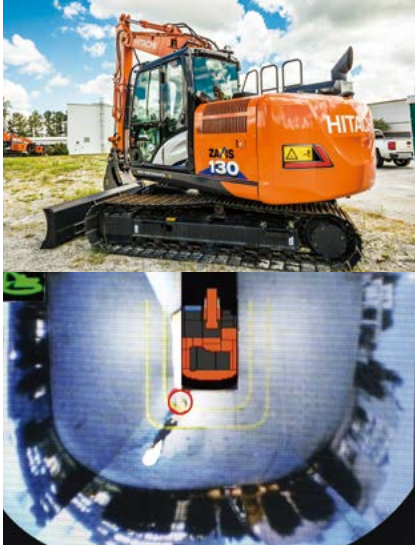
機体に搭載した物体検知センサとカメラで、機械を中心にした俯瞰映像を運転席内のモニターで確認できる「エアリアルアングル」。運転の安全性を高め、接触事故低減に寄与する機能だ。
