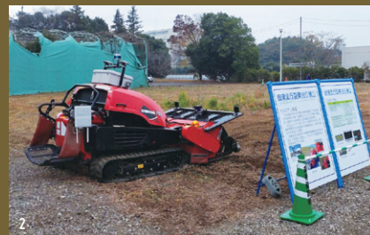
1. 現場でICT施工にあたるZX200X 2. 「建設DX実験フィールド」で実演した「自律走行型草刈り機」は、ベンチャー企業4社のスクラムで開発された。
