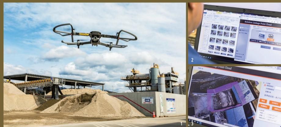
1. 撮影のために飛び立ったドローン。後ろに見える骨材の山は大きくえぐれているが、これでも正確に測定可能という。2. ドローンが撮影した画像データはドラッグアンドドロップでクラウドにアップする。3. 3次元点群データ化された画像で領域を指定すると、囲まれた部分の体積が計算される。紫色で四角に囲まれている範囲がその領域。
