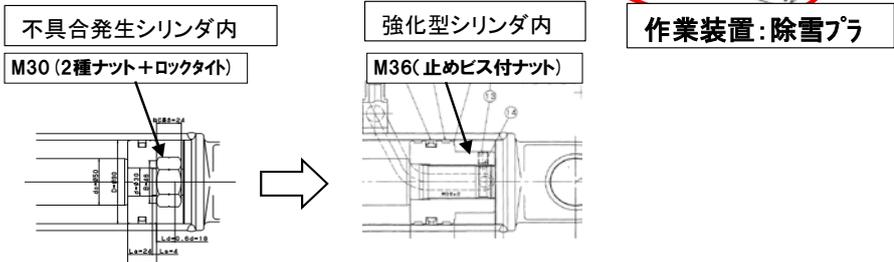
ショベル・ローダに装着している作業装置、除雪プラウにおいて、プラウをアングリングさせる油圧シリンダ(以後、アングリングシリンダ)が、作業中の衝突、衝撃によって、シリンダー内部が破損し、シリンダーが作動不良になり、作業ができなくなる。
