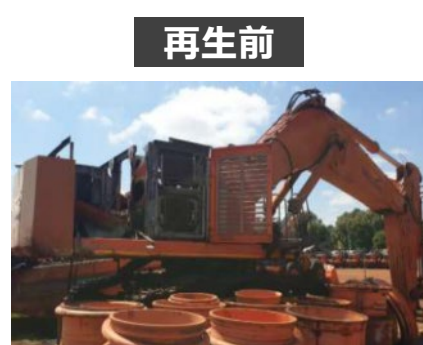
ザンビアで再製造した超大型油圧ショベル (2011年販売、21,950時間稼働)
