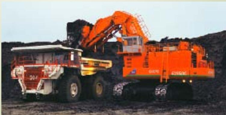
稼働中の超大型油圧ショベルと大型ダンプトラック
