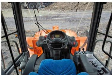
ピラレス化（ガラス面の拡大）によるワイドな視界確保や車両の状況を的確に把握する多機能液晶モニタを装備。
