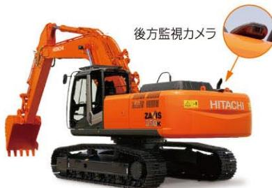
多様化する油圧ショベルの情報化に伴い大画面マルチモニタを採用し、メンテナンスインタール告知、燃料管理、盗難予防のデンキーロックシステム等トラブルの未然防止を実現しました。また後方監視カメラの映像を表示し作業時の安全性を飛躍的に向上させました。
