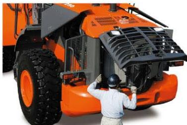
点検のし易い新型エンジンカバーの採用や点検個所の集中配置、レイアウト見直しにより点検を容易化。
