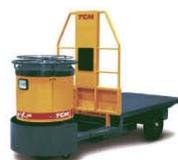
バッテリー式構内運搬車
