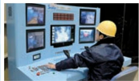
4本のレバーとさまざまなボタンでASTACO-SoRaを遠隔操作する操作盤。5面のモニターを切り替えながら監視。
