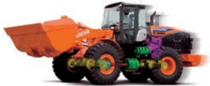
ZW220HYB-5B。ハイブリッドシステムに加え、油圧システムを更に高効率化するなど、従来機の作業性を損なうことなく、燃料消費量とCO<sub>2</sub>排出量を大幅に低減。
