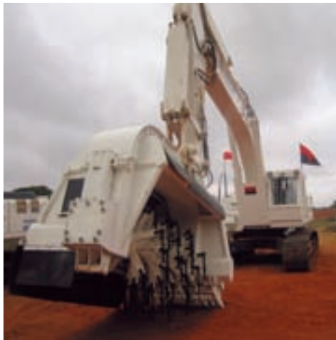
●フレールハンマー型地雷除去機
