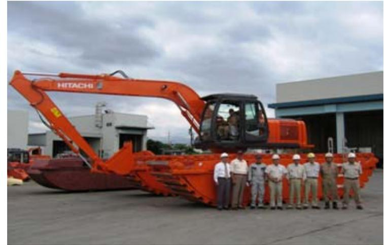
イラク向けMA200 (泥上掘削機)
