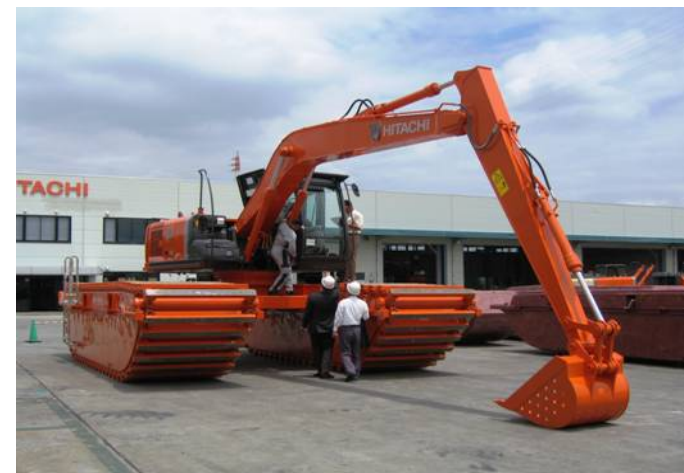
泥上掘削機 出荷前検査
