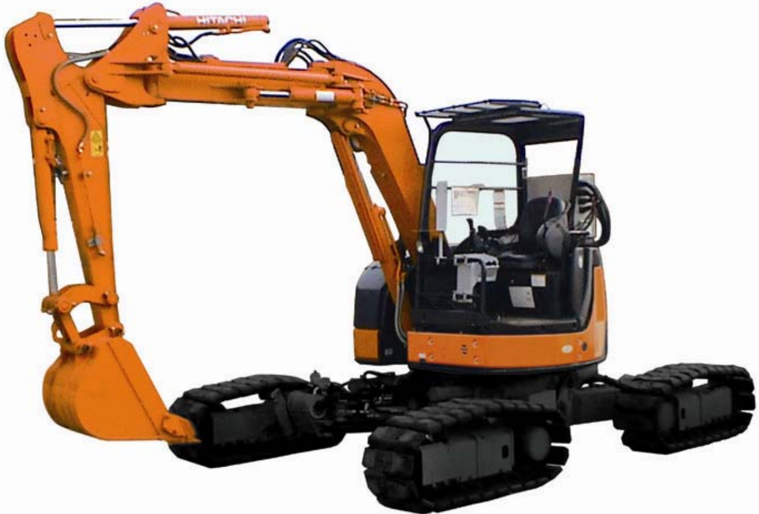
4脚クローラ式不整地掘削機 (「2010森林・林業・環境機械展示実演会」に参考展示)
