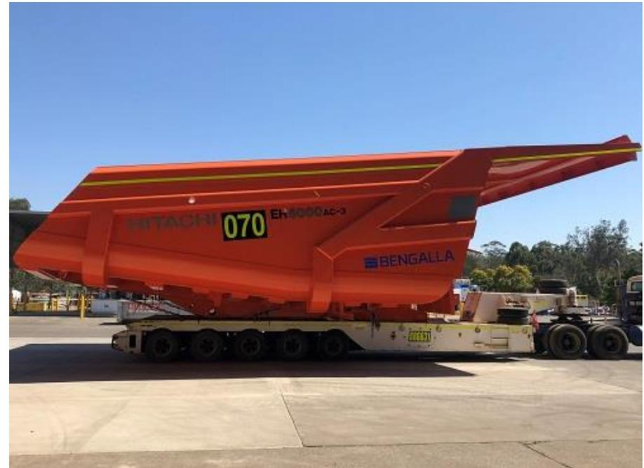
ブラッドケン社がオーストラリアのイプスウィッチ工場で製造した荷台。従来と比べて1割軽量化
