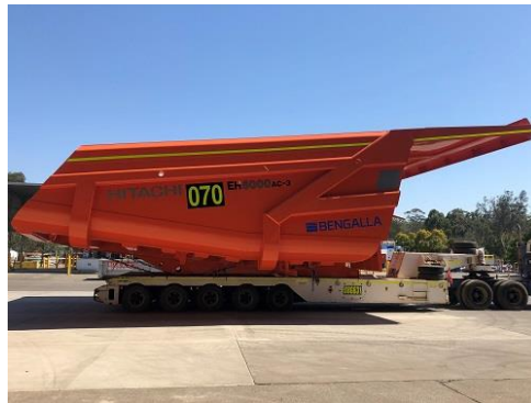
ブラッドケン社がオーストラリアのイプスウィッチ工場で製造した荷台。従来と比べて1割軽量化（2019年9月出荷開始）
