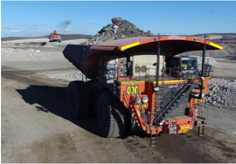
自律走行で稼働中のダンプトラック EH5000AC-3
