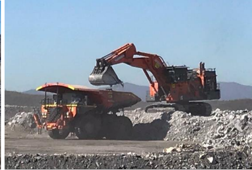
自律走行で稼働中のダンプトラック EH5000AC-3
