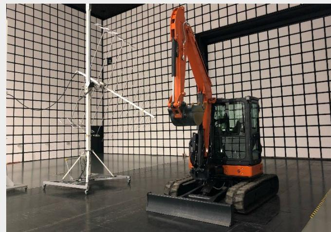
最新の電波暗室で試験中の5tクラス試作機
