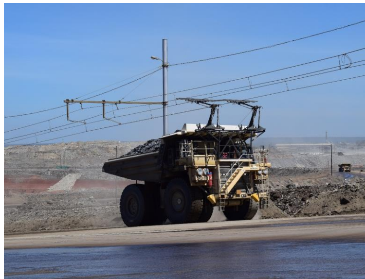
カンサンシ銅・金鉱山を走行する 日立建機のトロリー受電式ダンプトラック
