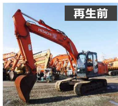
常陸那珂工場で再製造したZX200-3 (2007年販売、豪雨で水没)
