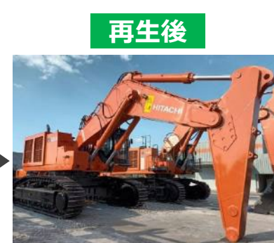
ザンビアで再製造した超大型油圧ショベル (2011年販売、21,950時間稼働)
