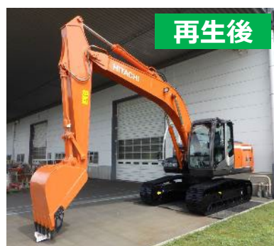
常陸那珂工場で再製造したZX200-3 (2007年販売、豪雨で水没)
