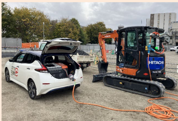
電動建機と移動式給電車の 安定稼働・最適な充電計画を実証
