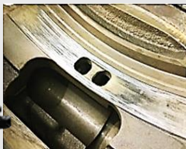
損傷を受けた メインポンプの内部部品
