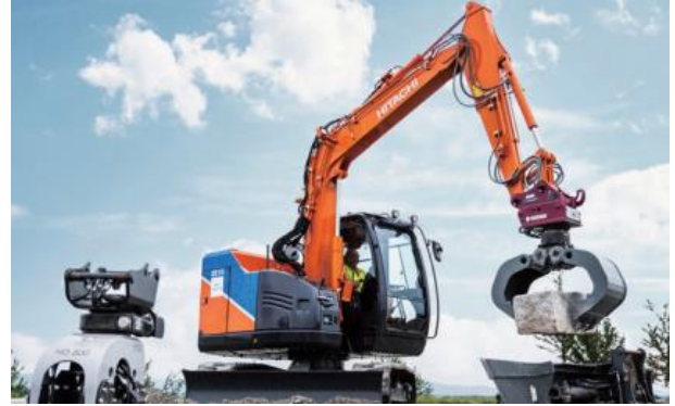
バッテリー駆動式ショベル（8トンクラス）の建設現場での使用イメージ
