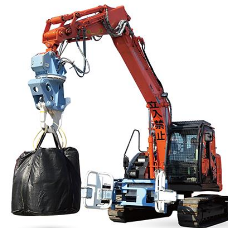
放射性汚染廃棄物土のう袋用 小型移動式クレーン仕様機
