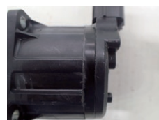
ひとつのモーターのように見えるが、実は右のように他機種用から部品を寄せ集めた改造品。
