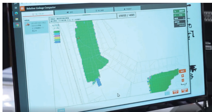
Web 上で転圧管理状況を確認
