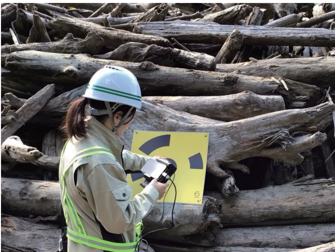
SL-Survey による対空標識座標取得
