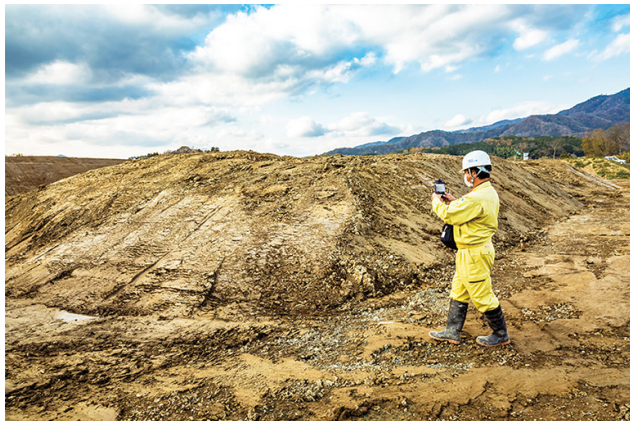
スマートフォンで撮影するだけで、土量を計測できるSolution Linkage Survey。
