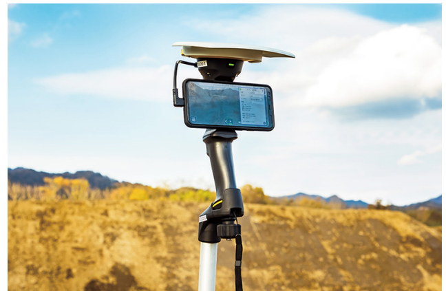
Trimble SiteVisionで、現状画像と3次元設計データをスマートフォン画面上に融合し進捗を確認。
