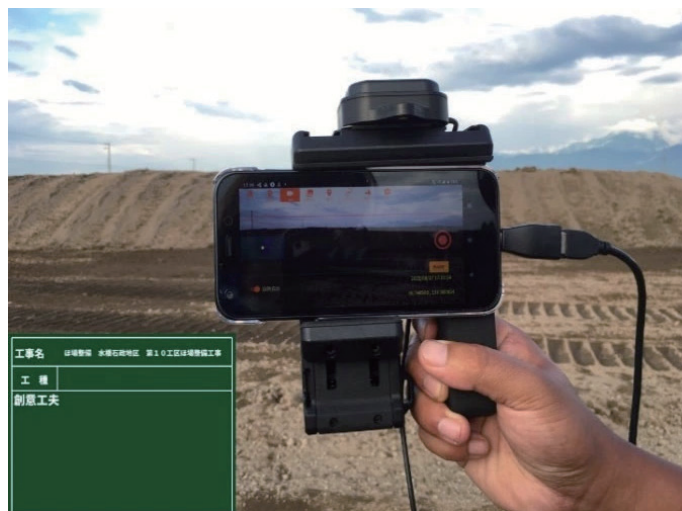
SL-Survey での土山撮影②
