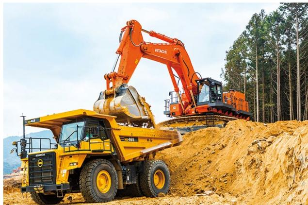
この工事のために導入された日立建機の油圧ショベルEX1200が、切土をダンプトラックに積み込んでいる。
