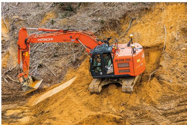
ICT施工に対応した日立建機の油圧ショベルZX225USRが稼働している。のり面形成はもちろん、傾斜のある土地地で大きな効果を発揮している。
