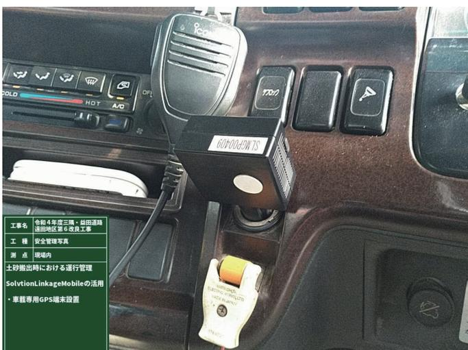
ダンプトラックのシガーソケットに車載専用 GPS 端末を設置
