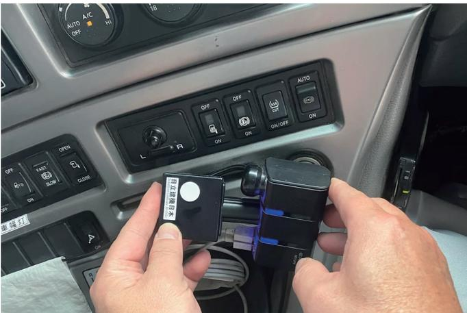
車載専用 GPS 端末でダンプトラックの位置情報を取得
