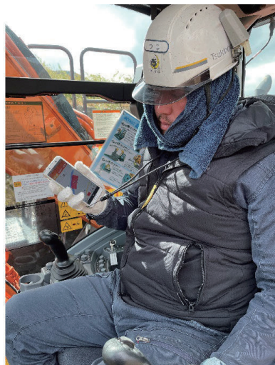
SL-Mobile スマートフォンがダンプトラックの接近を通知
