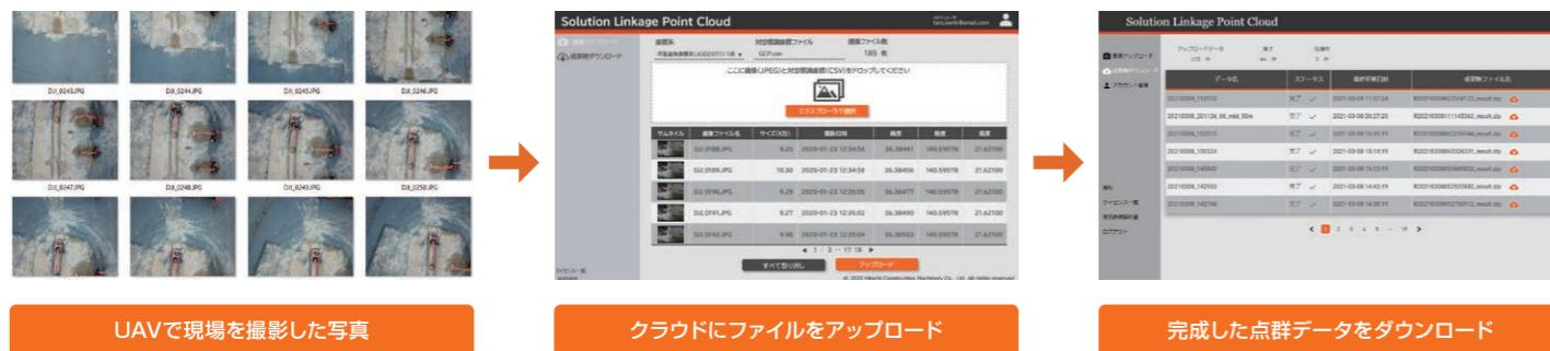
\* 時系列でデータを比較したり、起工測量データと比較する場合は、現場に標定点と検証点を設置してトータルステーションなどで座標測定し、クラウドでの点群生成の際に入力が必要です。専用の標定点マーカーでない場合は、別途写真1枚ごとに座標指定してください。
