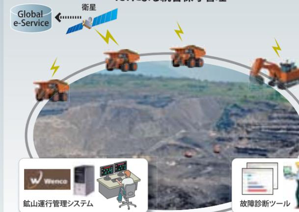
ICTを駆使して建設機械の稼働状況を捉える「Global e-Service」と「鉱山運行管理システム」を組み合わせることで、機械故障によるダウンタイムの低減を図るほか、鉱山全体の効率運営にも貢献。
