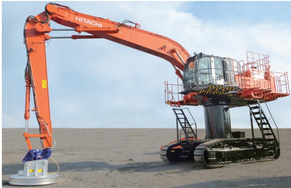
お客様の個別ニーズに応える「応用開発製品」。細い木材1本も楽につかめる専用グラブブルを搭載した「ZX170WM-3ロググラブブル仕様機」(左上)。回転アームで鍋の隅々までスラグ除去を可能にした「ZX75US-3電動式取鍋解体仕様機」(左下)。視界良好でワイドな作業範囲を確保した「ZX450LC-3ハイポスト式マテハン仕様機」(右)
