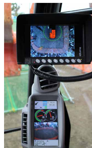
油圧ショベルに搭載した「Aerial Angle」
