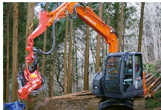
林業専用の大型足回りを採用した林業仕様機
