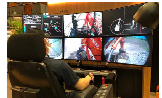
映し出されるモニターを見ながらショベルを遠隔操縦するオペレータ
