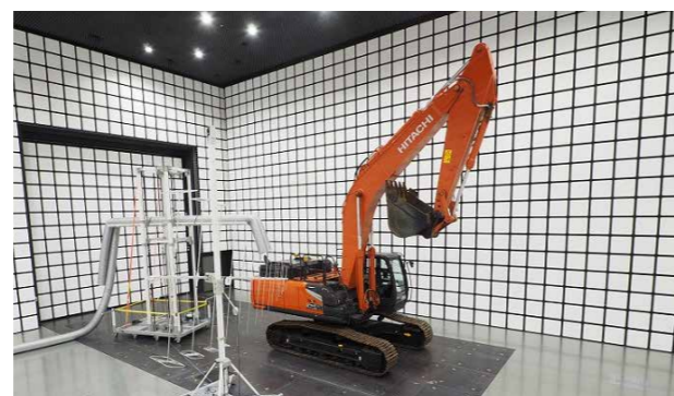
油圧ショベル（30トンクラス）の EMC 試験の様子（イメージ）
