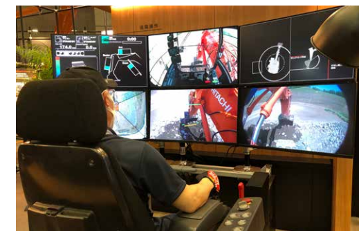
映し出されるモニターを見ながらショベルを遠隔操縦するオペレータ
