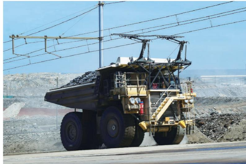
カンサンシ銅・金鉱山を走行する日立建機のトロリー受電式ダンプトラック
