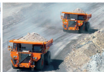
自律走行するダンプトラック
