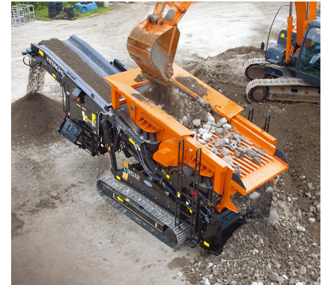
被災現場で発生した土砂などの分別処理に、自走式スクリーンが活用できる。
