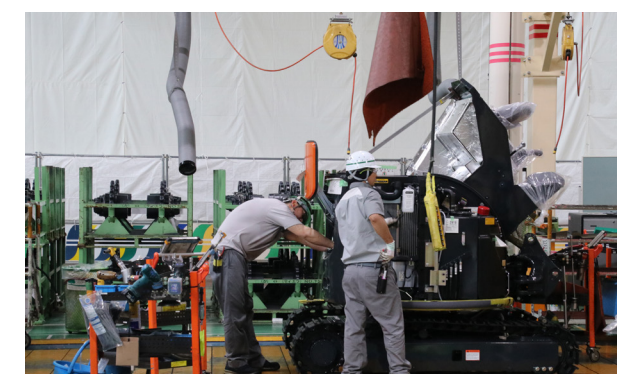
階段の昇降や高所での作業を極力なくし、腰をかがめず作業できる高さに。工具ワゴンもコンベアラインで作業者と一緒に移動し、持ち運びの負担も軽減。
